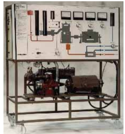
P8150 Banc d'essai simple pour un moteur monocylindrique à 4 temps.
