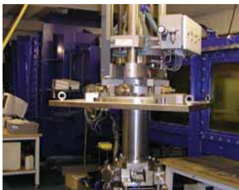
R102 Balance Multi-Composante avec Mécanisme de Réglage de la Hauteur et de l'Inclinaison
